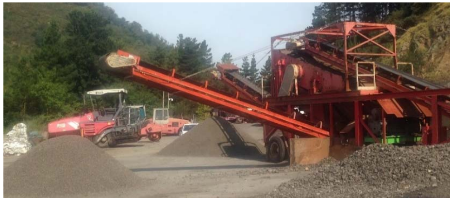
Figura2. Clasificación del material de fresado en varias fracciones.
